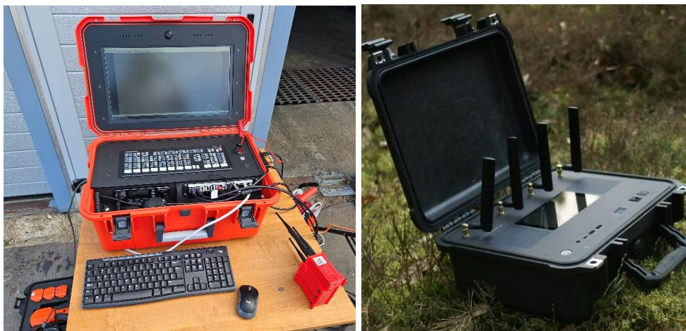
Rysunek 3. Zestawienie wybranych systemów do bezprzewodowego przesyłania danych z BSP w czasie rzeczywistym. Po lewej stronie – Mobilne Centrum Dowodzenia (RPASAR), po prawej – ACO Streamer 4K LTEA (ACO Solutions).
