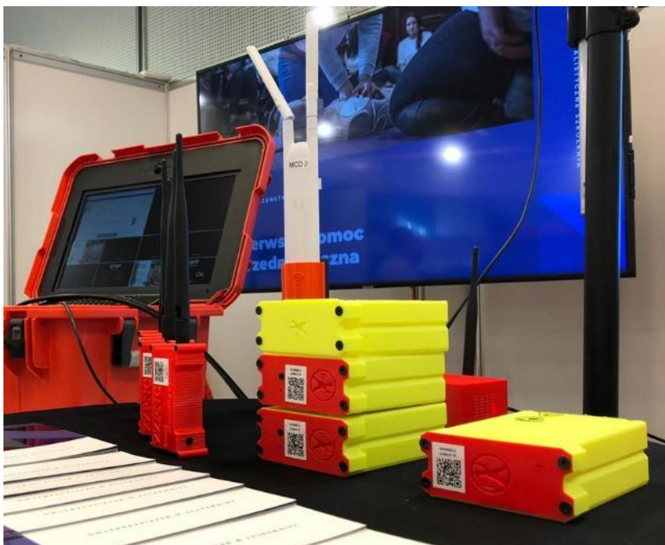
Rysunek 1. Liczniki Geigera gotowe do zamontowania na bezzałogowym statku powietrznym. Źródło: RPASAR/OSP Niegoszowice.
