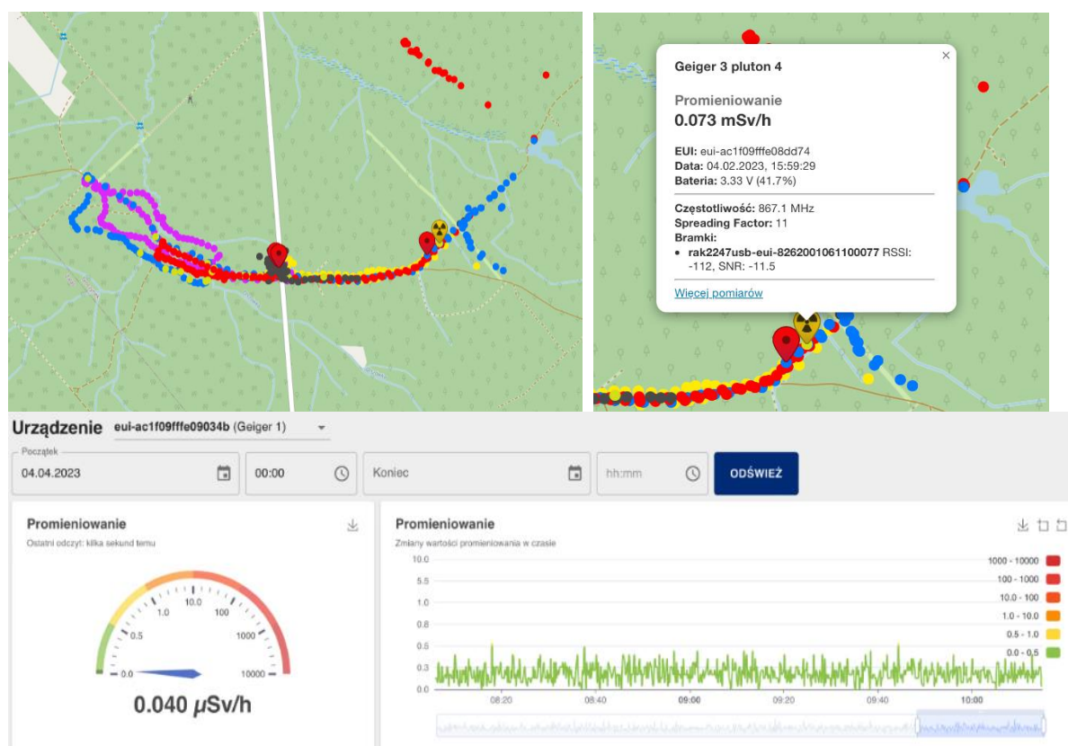
Rysunek 2. Zestawienie zarejestrowanej trasy lotu bezzałogowego statku powietrznego z zamontowanym licznikiem Geigera oraz wyniki pomiarów promieniowania. Źródło: OSP Niegoszowice.
