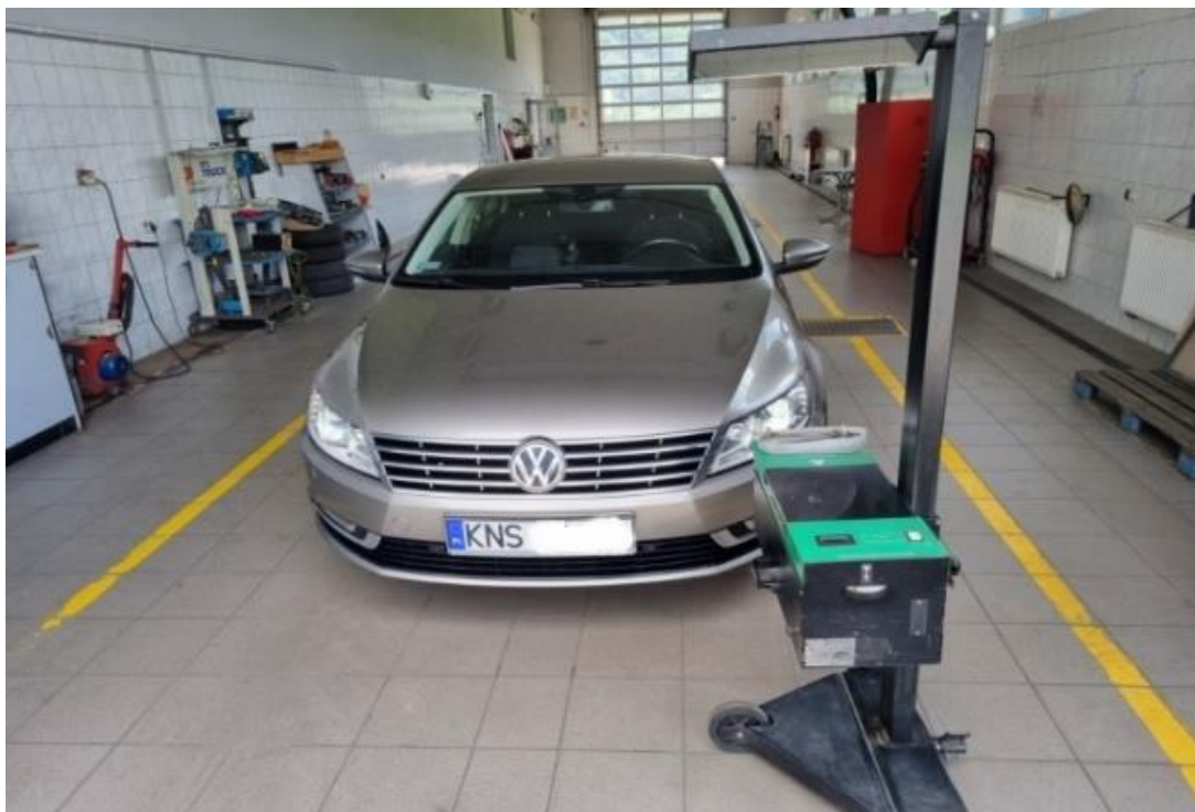
Rysunek 39. Przykład zastosowania urządzenia do pomiaru regulacji świateł drogowych i świateł mijania. Źródło: opracowanie własne na podstawie własnych zdjęć pozyskanych ze stacji kontroli pojazdów w Łącku i Krynicy-Zdrój.
