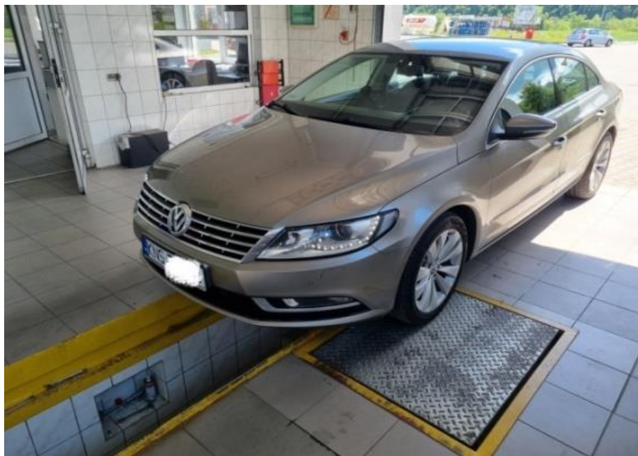
Rysunek 35. Przykładowy, wstępny pomiar ustawienia zbieżności kół na urządzeniu SP4200. Źródło: opracowanie własne na podstawie własnych zdjęć pozyskanych ze stacji kontroli pojazdów w Łącku i Krynicy-Zdrój.
