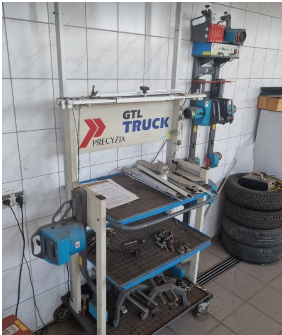
Rysunek 25. Przykładowy przyrząd do kontroli geometrii kół i osi dla pojazdów powyżej 3,5 [t]. Źródło: opracowanie własne na podstawie własnych zdjęć pozyskanych ze stacji kontroli pojazdów w Łącku i Krynicy-Zdrój.
