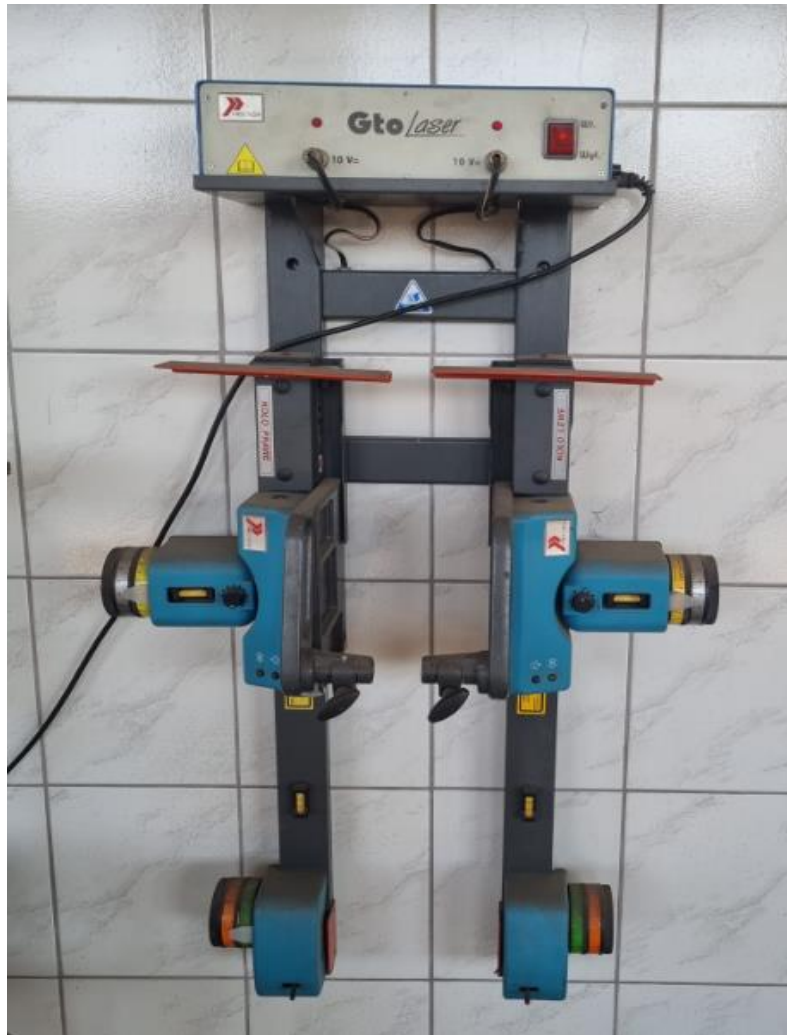
Rysunek 24. Przykład urządzenia do kontroli geometrii ustawienia kół i osi pojazdu GTO Laser. Źródło: opracowanie własne na podstawie własnych zdjęć pozyskanych ze stacji kontroli pojazdów w Łącku i Krynicy-Zdrój.
