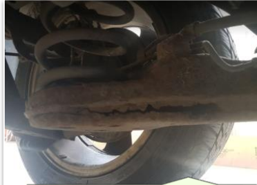
Pęknięcie wahacza pojazdu osobowego z powodu korozji
