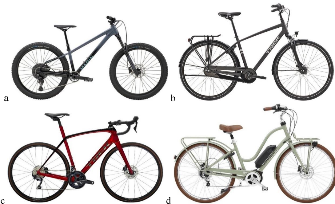
Rysunek 4.2. Przykłady rozwiązań konstrukcyjnych rowerów: a) rower górski, b) rower turystyczny, c) rower szosowy, d) rower elektryczny (turystyczny).
