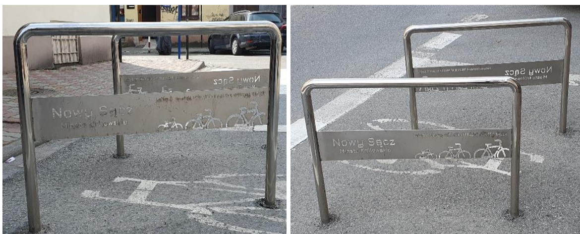
Rysunek 2.12. Stojak w kształcie odwróconej litery U. Źródło: opracowanie własne.
