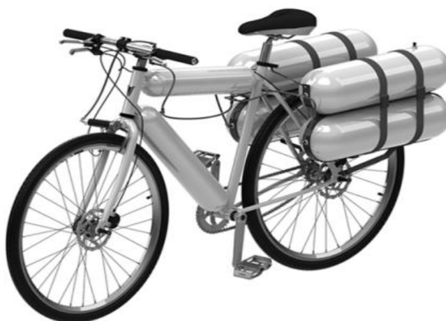
Rysunek 4.5. Projekt konstrukcji innowacyjnego roweru z dodatkowym napędem pneumatycznym.
