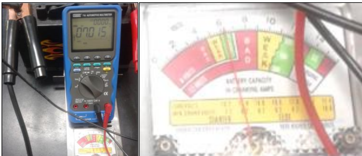
Rysunek 4. Pomiar napięcia pod obciążeniem automatycznym testerem obciążeniowym. Źródło: opracowanie własne.
