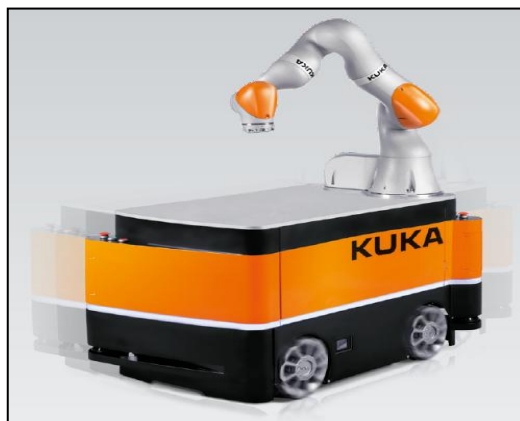
Rysunek 1. KMR iiwa – mobilny robot przemysłowy przystosowany do pracy z ludźmi.
