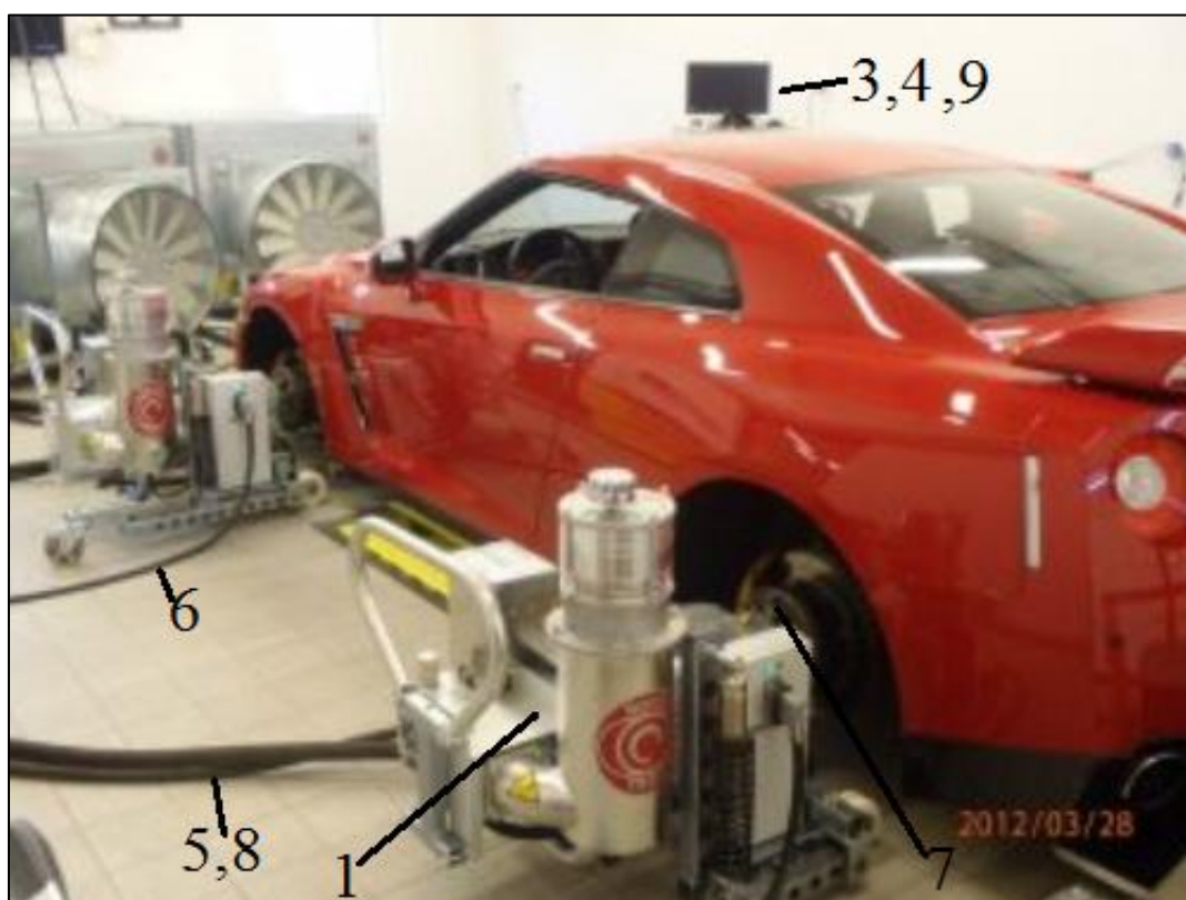
Rysunek 4. Przedstawienie elementów wchodzących w skład hamowni ROTOTEST. Źródło: www.kingsoft.com.pl (dostęp: 23.01.2017).
