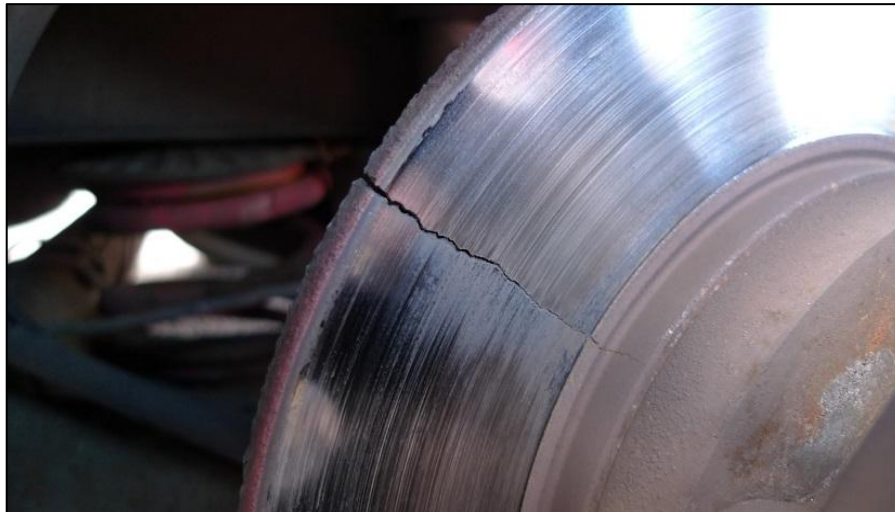
Rysunek 3. Pęknięcie tarczy hamulcowej Źródło: www.warsztatowiec.info (dostęp: 22.12.2016).
