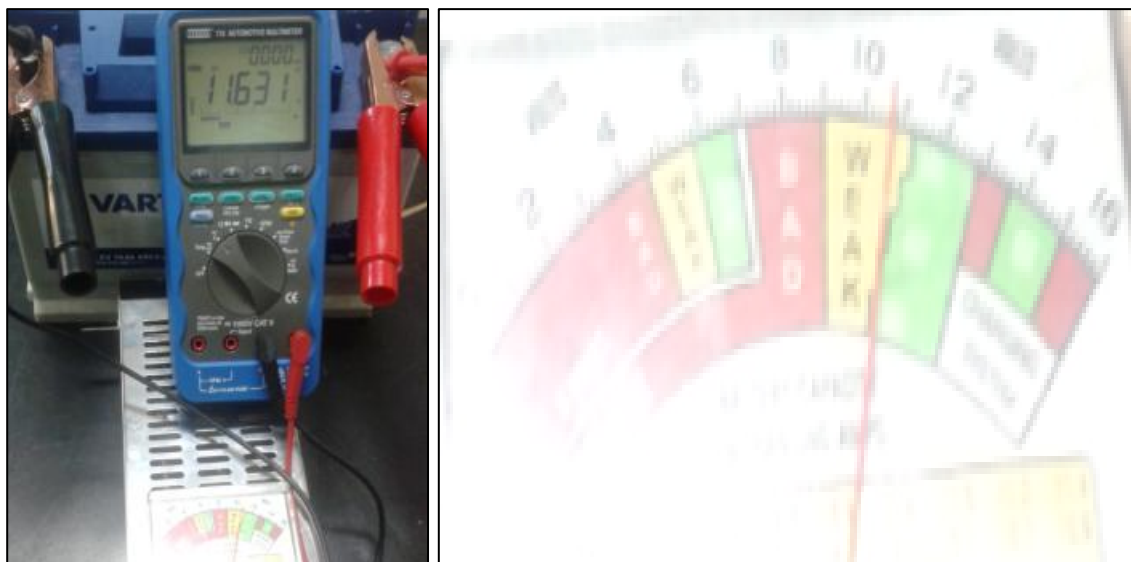
Rysunek 5. Pomiar testerem obciążenia. Źródło: opracowanie własne.
