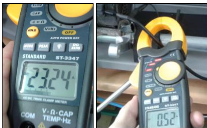
Rysunek 10. Pomiar prądu ładowania (po lewej) i prądu wzbudzenia (po prawej). Źródło: opracowanie własne.
