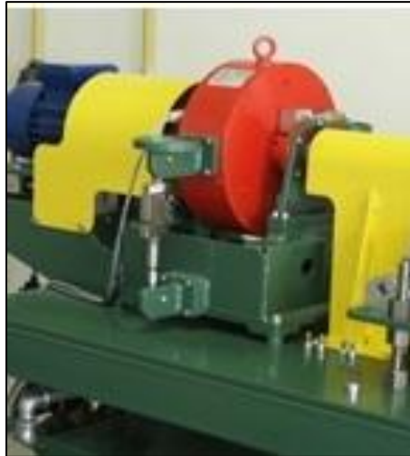
Rysunek 7. Hamulec elektrowirowy EMX-10/18000. Źródło: www.elektromex.arg.pl (dostęp: 20.01.2017)
