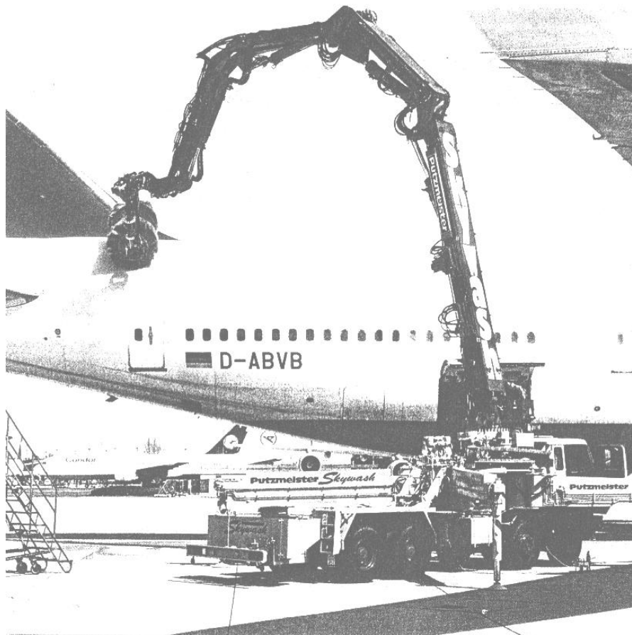
Rys. 2.17. Robot SKYWASH na podwoziu 8-kołowym w działaniu (czyszczenie powierzchni kadłuba samolotu (B 747/400)). (Źródło: Morecki, Knapczyk, 1999)
